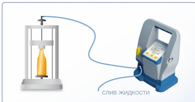
Проверка содержания растворенного кислорода в пустом резервуаре дозревания
