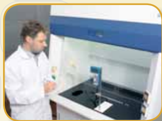
Измерение скорости потока воздуха
