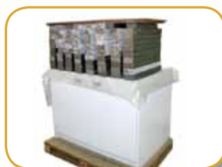
Реальная фотография во время испытания на загрузку шкафа
