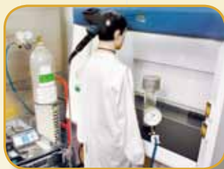
Испытание на сдерживание с помощью газа-индикатора (SF 6 )
