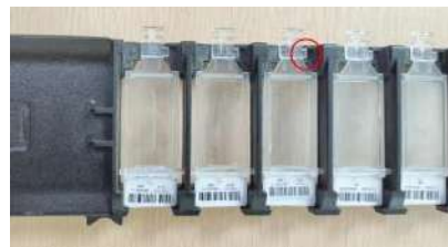
Рисунок 3.14: Крышка для жидкого покрытия препарата и её установка (стрелка указывает на крепление крышки для жидкого покрытия),.
