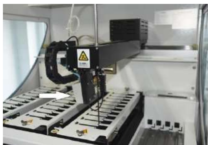
Рисунок 3.4: Роботизированный манипулятор, стрелка указывает на сканирующий модуль
