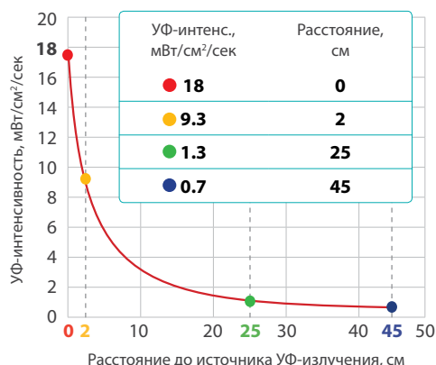
Рис. 1.1. Падение интенсивности УФ в зависимости от расстояния до поверхности источника УФ
