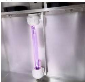
Система УФ-рециркуляции воздуха внутри камеры
