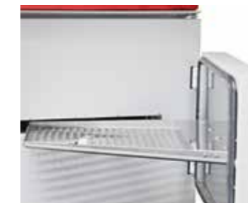
Безопасный сушильный шкаф с дополнительной выдвижной секцией для образцов, обрабатываемых по технологии Coil Coating
