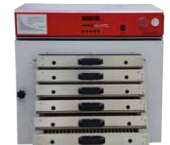
Безопасный сушильный шкаф с телескопическими выдвижными секциями
